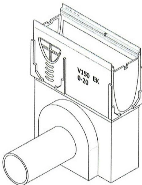
ACO DRAIN Multiline Rinnensystem für die Verwendung in LAU-Anlagen
