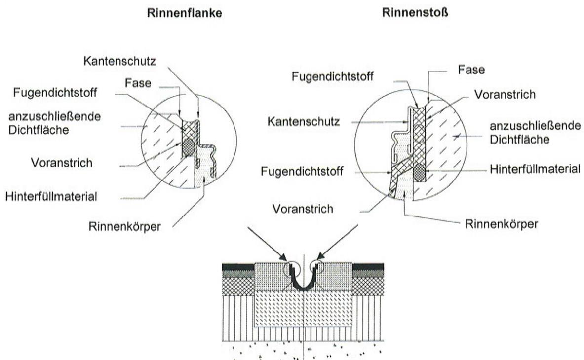
ACO DRAIN Multiline Rinnensystem für die Verwendung in LAU-Anlagen
