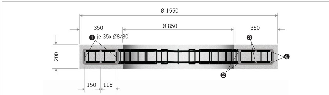
**Biegeliste/ Bending schedule****Lastverteilerplatte Ø1550/850x200, Stahl: BSt 500 S /****Load distribution plate Ø1550/850x200, steel: BSt 500 S**
