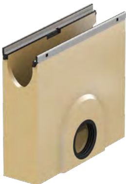
Einlaufkasten aus Polymerbeton mit Stahlkante, Bauhöhe 450 mm, DN/OD 110 oder 160
